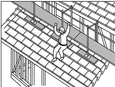
③作業中、足場から屋根面へ飛びおりたり、物を落としたりするとヒビ割れ、破損を生じ、雨漏りなどクレームの原因となりますので注意、指摘して下さい。
